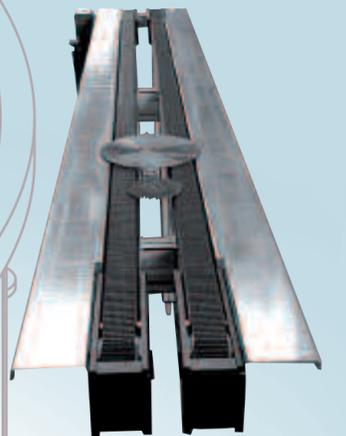
Il trasportatore a nastri è composto da una struttura modulare costituita da due binari paralleli in cui sono fissate delle guide a basso coefficiente di attrito.
